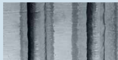
Confronto stabilità dell'arco con VARIGON® S (sinistra) e Argon (destra)
