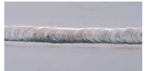
Retro del cordone di saldatura con protezione a rovescio
