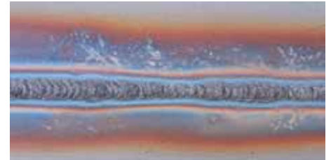
Retro del cordone di saldatura senza protezione a rovescio
